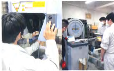
鉄筋引張試験
