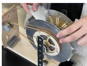
用水路発電のための水車を材料調達から設計、製作まで自ら行う
