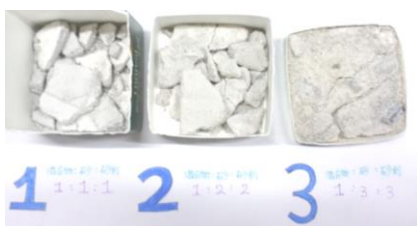
図7 ローマンコンクリートの試作品
