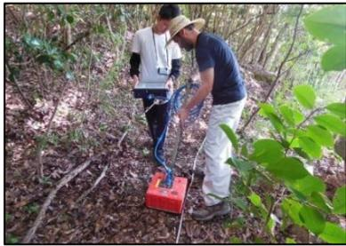
図5 地中レーダーによる調査の様子
