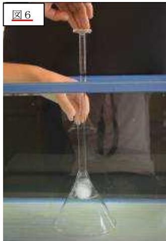
結果：急冷して結晶化した氷は、実験（2）で膨張率や密度の変化率に有意差を示さないが、多くの空気を気泡として含む。多くの空気が閉じこめられているにもかかわらず、急冷した氷の方が膨張率はむしろ小さい傾向にある（表2）。
