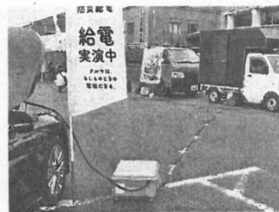
「MIRAI」からの給電でキッチンカー2台が稼働
