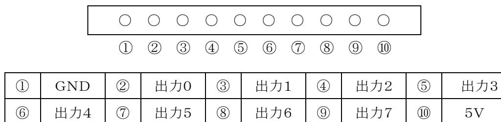
図4 接続ケーブルC用コネクタのピン配置
