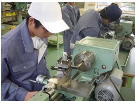
工業技術基礎(機械加工 旋盤実習)
