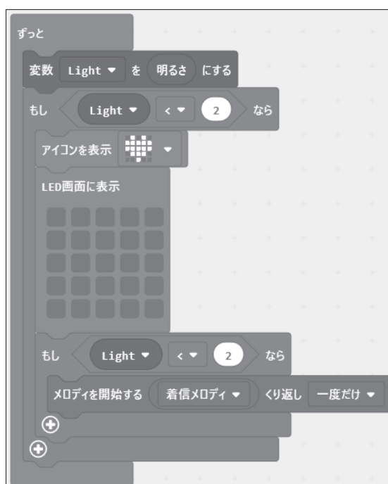
図 9 図 8 の micro:bit への基本プログラム
