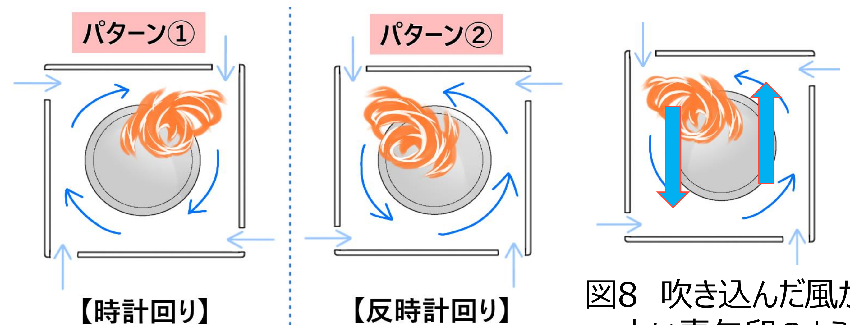
図7 パターンを変えることで、火災旋風の回転方向が変わった。
