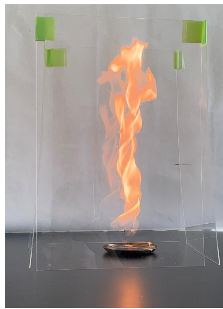
図1 実験1-1で発生した火災旋風
