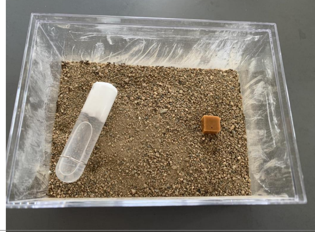
図2：実験装置。左の試験管は、脱脂綿で栓をした水。右は、キャラメル。
