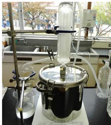
水蒸気蒸留装置
