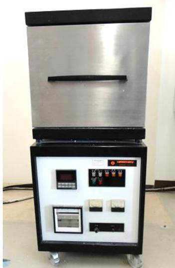
超高速昇温電気炉
