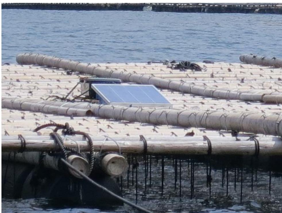
筏に取り付けた海面5mの海中に空気を送る装置
