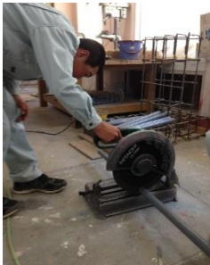
▲支柱台に取り付けるパイプを加工
