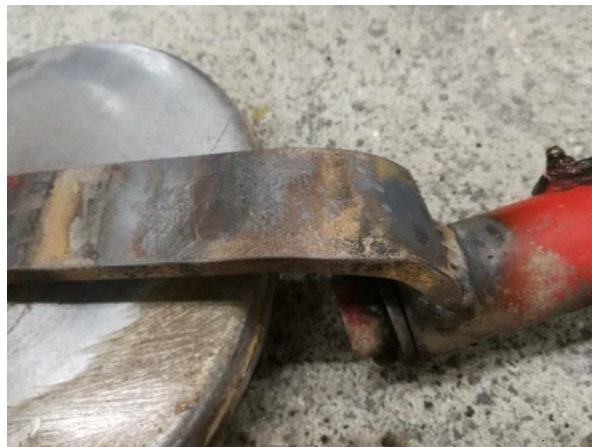
② 曲がった部分をガスであぶって修正
