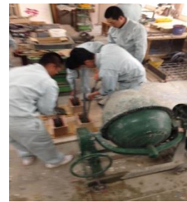
▲支柱台コンクリートミキサー使用
