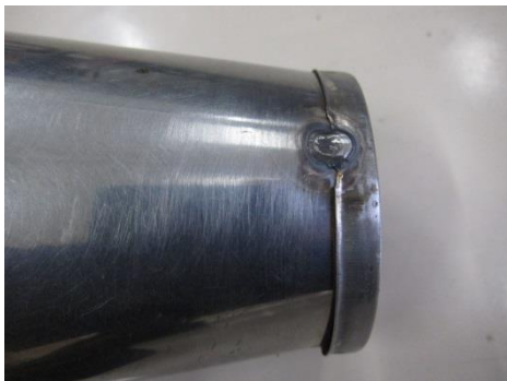
① 外れていた溶接部分の修繕
