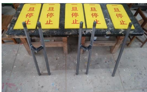
▲一旦停止看板と支柱の加工
