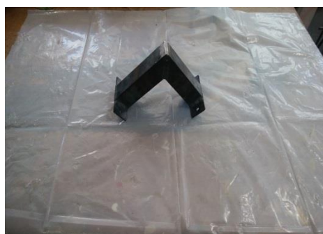
▲鉄製角パイプをL字に部品加工
