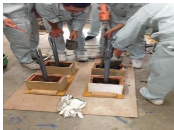
▲空気を十分に抜くため振動を与える
