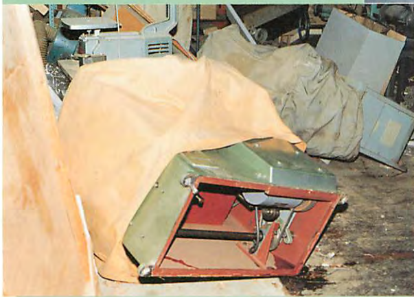
旋盤が床から根こそぎ倒れてしまった (神戸市立烏帽子中学校技術室)
