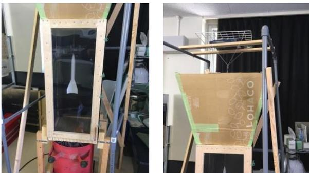
図1 自作風洞装置 (測定胴と送風機 [左図]、縮流洞 [右図]) 木材と塩ビパイプで作成した。測定洞は縦 30cm×横 30cm×高さ 91cm の大きさを図1のように中にロケットの機体を吊るし、上部の電子天秤で質量の増加を求める。
