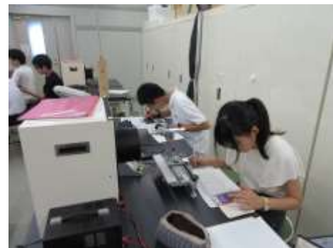
電子軌道を測定したデータから計算して比電荷を求めているところ
