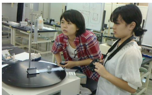
デジタルカメラでバネはかりの値を測定
