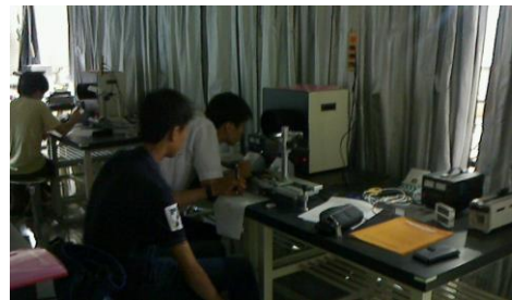
比電荷の装置で電子軌道の外径を測定しているところ
