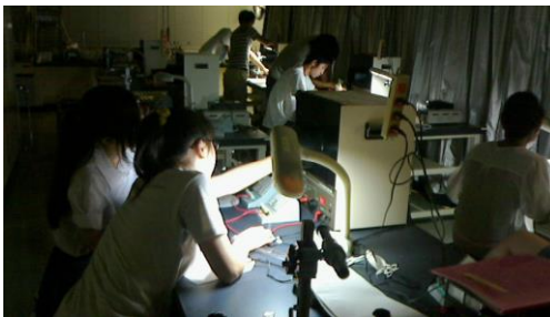
比電荷の装置で電子軌道の外径を測定しているところ
