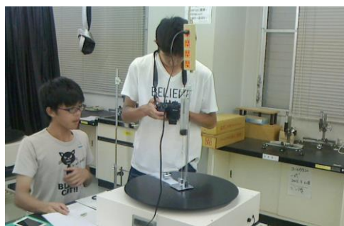
デジタルカメラで回転円盤のおもりを測定
