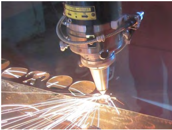
レーザー加工機稼働 1
