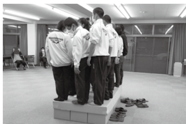
▲段ボールベッドの強度確認の様子
