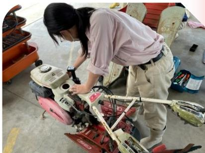
長く使用されていなかった管理機、エンジンはかかります。スロットルを上げると、途端に停止・・・。不調部位を探っています。機械庫にあるコンバインは秋の収穫期のみ稼働。放っておくとバッテリーが放電されてしまうため、定期的に充電。カバーを外し、ターミナルにケーブルをつなぎ、完了です。
