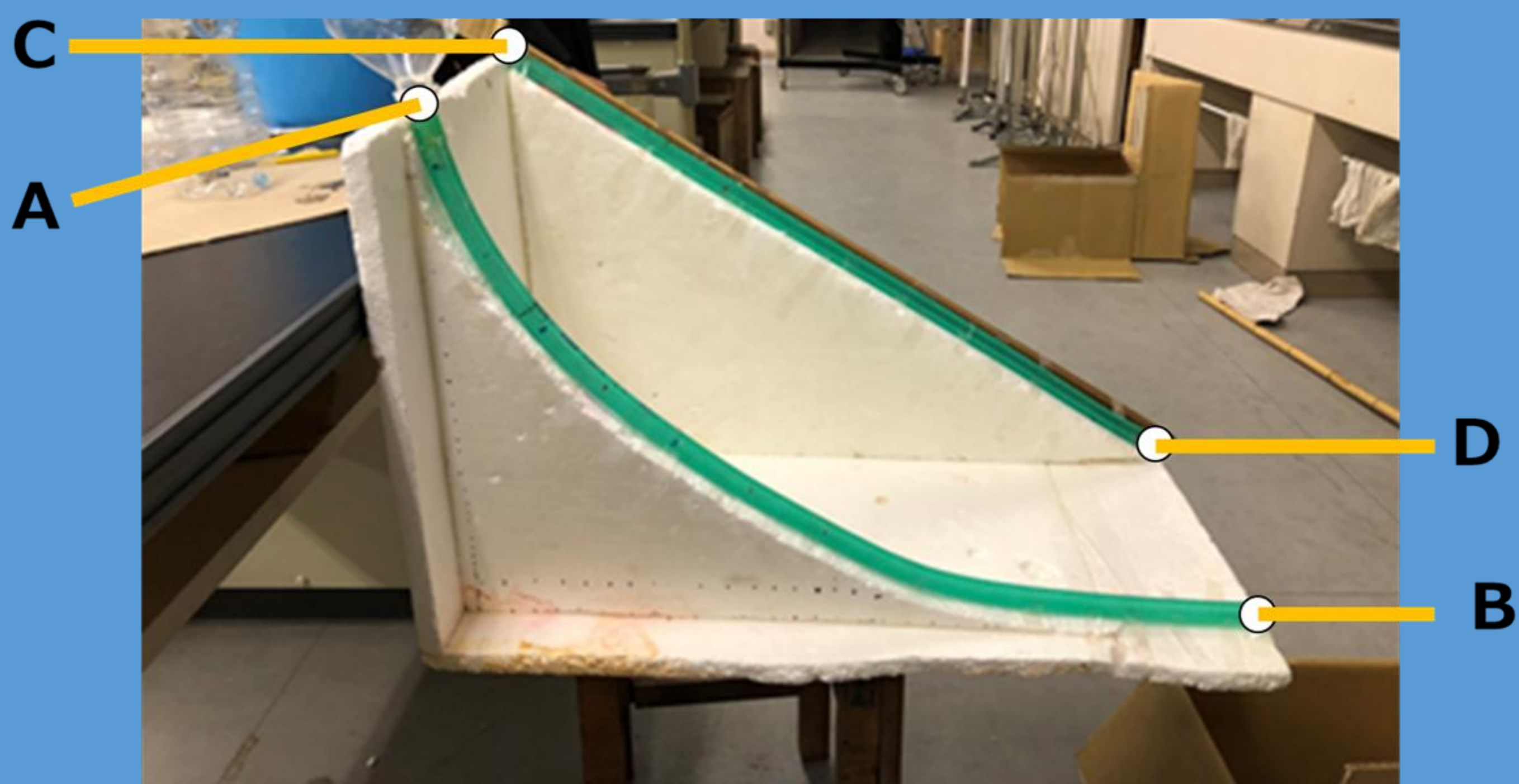
図2 実験装置の写真 (手前の経路がサイクロイド曲線)
