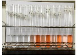
図5 溶存鉄の濃度測定
