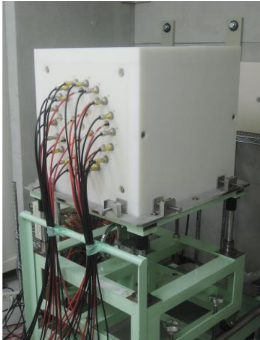
図 6 平坦効率中性子検出器。高密度ポリエチレン中性子減速材中に 10 気圧の ^3\text{He} 比例計数管 31 本を三重リング状に（半径 5.5cm のリングに 4 本、13.0cm のリングに 9 本、16.0cm のリングに 18 本）配置してある。
