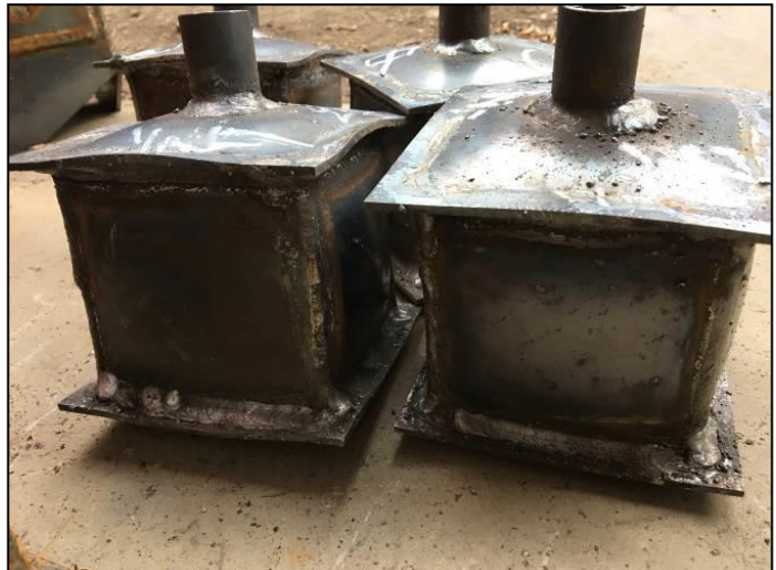
水圧検査後の膨らんだ圧力容器
