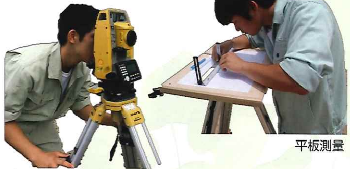
トータルステーション (高性能測量機器)
