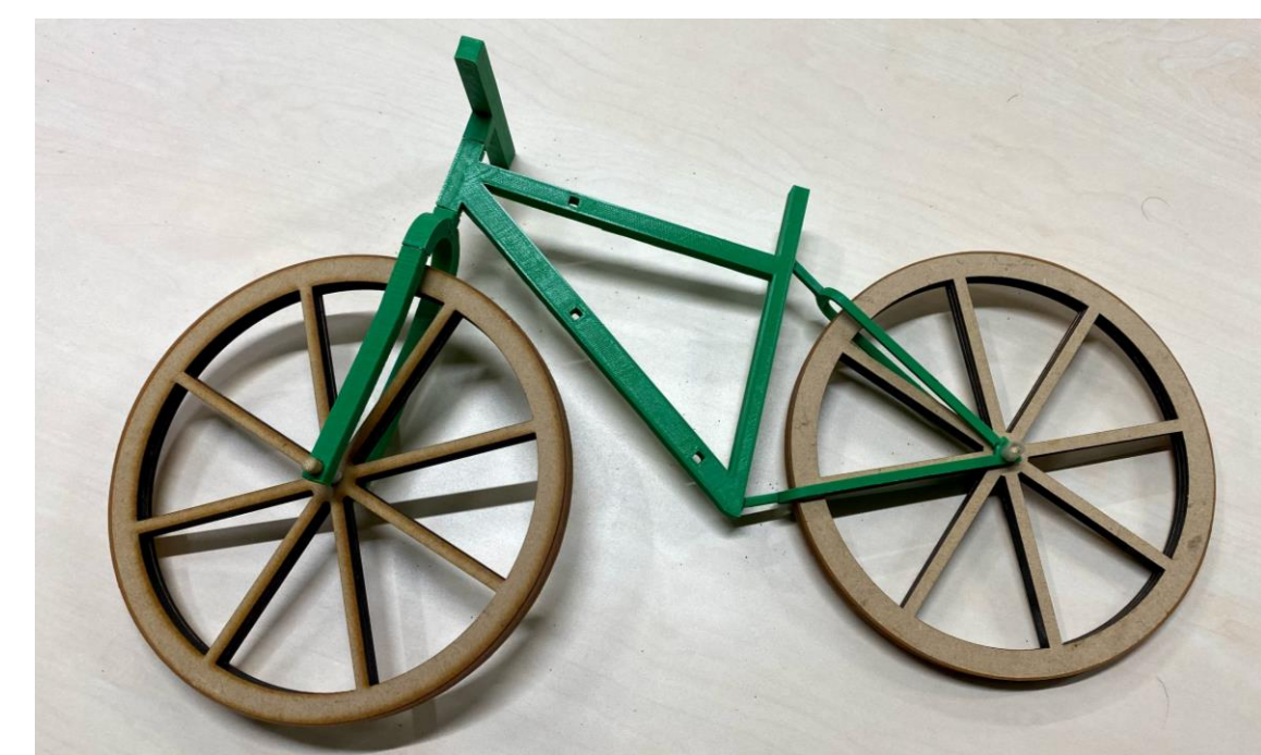
図5 試作品3号 フレーム：ポリエステル樹脂（3Dプリンタ） タイヤ：木材（レーザー加工機）
