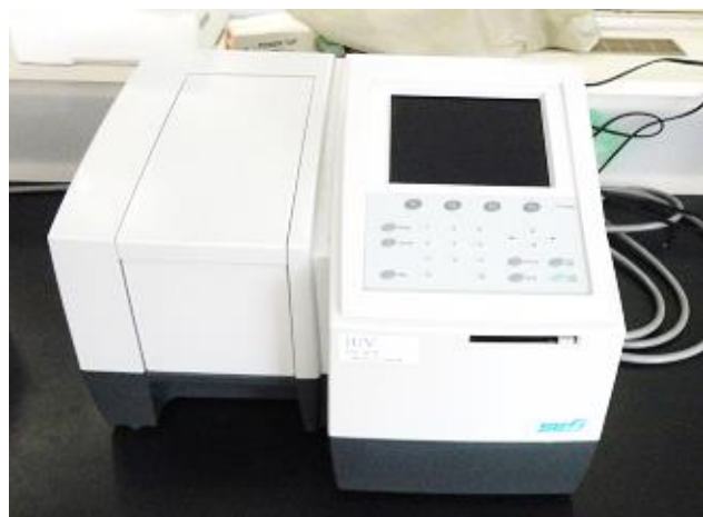
紫外可視分光光度計 SHIMADZU IUUV-1240
