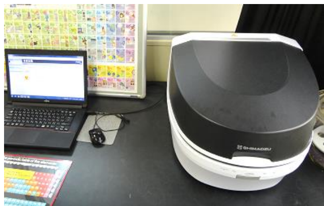
紫外可視分光光度計 SHIMADZU IUUV-1240
