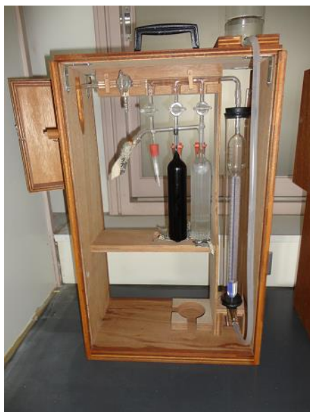
オルザットガス分析装置 SHIMADZU EDS-7000
