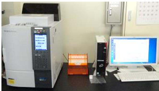
ガスクロマトグラフ分析装置 SHIMADZU GC-204
