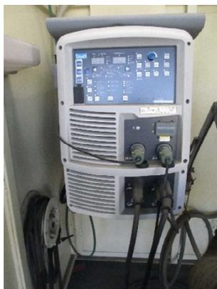
T I G 溶接(タングステンイナートガスアーク溶接)は、近年、企業での導入が進みガスタービンブレードなどの精密な溶接作業が多くなっている。電気科では、基礎的な溶接作業は実習で行うが、技術的には低いレベルにある。デジタルT I G 溶接機の導入により、リモコンによる電流調整やデジタルインバータなど企業で行われている最新のT I G 溶接作業を容易に行うことが可能となった。
