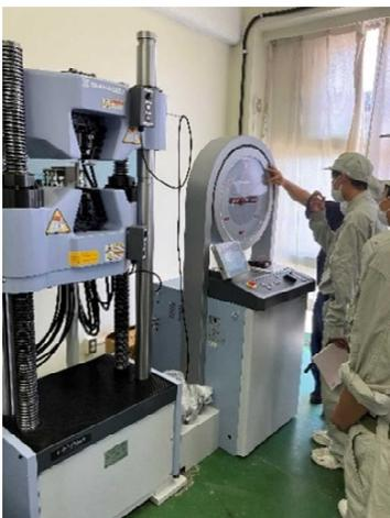
従来の万能試験機は、設置後かなりの年数が経過しアナログ式で正確な実験データを得ることが難しい状況だった。この万能試験機の導入により、従来の試験データから導いた計算結果を、コンピュータに保存したデジタルデータと比較することが可能になり、今まで以上に引張試験に関する知識が深まる実習を行えるようになった。
