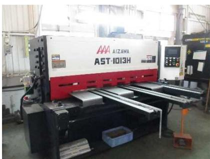
更新されたメカニカルシャーは、デジタル化によって自動寸法計測、切断材料カウントなど今までにない機能が備わり、溶接練習材料の準備が時間短縮、省力化された。
