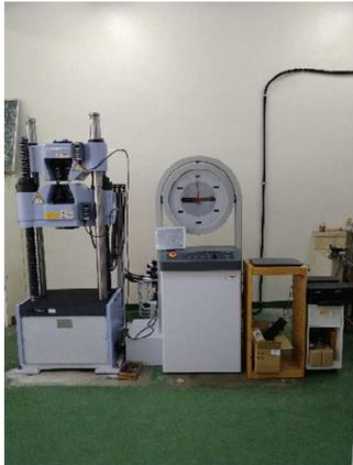
材料試験実習において、各生徒に一本ずつの機械構造用炭素鋼鋼材の 4 号試験片を配布し、引張試験、組織検査、火花試験、硬さ試験から炭素鋼の種類、炭素量を調べる。以前の試験機では、試験準備に手間がかかり、試験速度が遅いため、1 人一本ずつの試験片を行うことができなかった。その為<sup>②</sup>に数人ペアで一本の試験を行っていた。本試験機により、試験効率が抜群に向上することができ、生徒それぞれが与えられた材料に責任を持ち理解を深めることができる。
