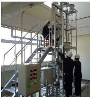
大きな工場などで石油類やアルコール類の精製に用いられている装置を小型化した装置である。連続的に一定濃度のアルコール等を精製し回収することができる。化学工学分野の実習に活用され、理解の深化の手がかりとして非常に重要な装置である。さらに、デジタル化されたことにより、データの読み取り等の作業が簡便なり、原理原則の理解をより深く時間をかけて行うことができるようになっている。
