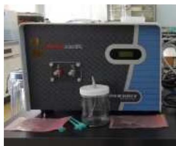
材料分析並びに有機合成・新たな材料づくりにとって必要不可欠な装置である。実習などで合成した試薬等の分析が構造単位で可能である。最近では、品質管理や異物混入を見極めるためなど多岐にわたる利用が進みつつある装置である。デジタル化によるデータベース時代に対応可能な仕様となっている。これまで、NMRは維持管理に液体窒素が不可欠であり、維持管理の点で導入が非常に難しかったが、近年の技術革新により非常に簡便な装置として進化しており、ランニングコストも液体窒素も必要なく利用できるようになり導入ができた装置である。
