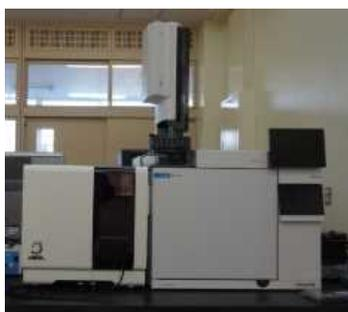
質量分析装置とガスクロマトグラフ分析装置が合体した装置である。これまで以上に見えないものが見える化され、とても分かりやすく学びを深化させることができる装置である。質量分析装置によって、ガスクロマトグラフ分析だけでは理解することができなかった情報を得ることができ、素材・材料化学分野における理解をさらに深化させることができる。また、デジタル化により、データベース時代にも対応した仕様となっているので、不明な物でも明確に理解することができ、実習・課題研究において活躍している。
