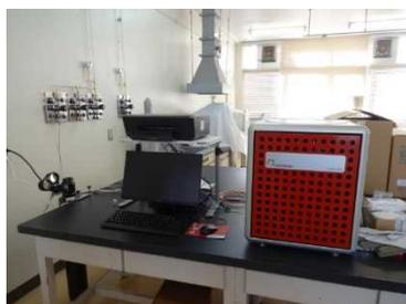
有機素材・材料の元素含有率を求めることができる装置である。素材メーカーや企業の分析部門には多く導入されている装置である。炭素・水素・窒素の組成を正確に求めることが可能で、有機化学分野の基礎分野の理解の手助けとなるデータが得られる。非常に初歩的な原理によって成り立っている装置であり、装置の原理の理解も容易で、有機化学の理解の深化の手助けとなるデータが得られる。
