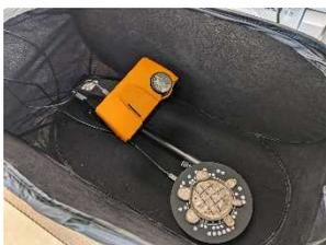
粘土等でモデルを作り、それをデジタルデータに置き換える目的などで使用している。出来上がったデータは、PCで加工したり、3D-CADで製作することもできる
