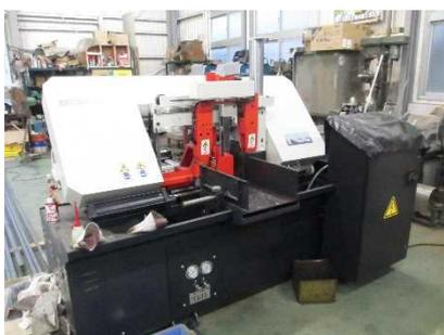
デジタル化されたバンドソーの導入によって、自動寸法切断が行え、空いた時間を他の作業に使えることが可能になり、教員の実習材料準備の負担が大幅に削減された。
