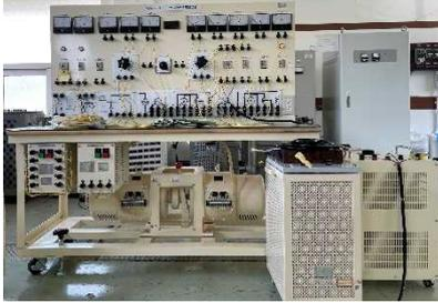
電気自動車の電動機は三相同期電動機が使用されている。本装置を用いることで、直流誘導電動機と三相誘導電動機、三相同期電動機の特性について学ぶことができる。電動機の特性について理解し、発展的な学習へと繋げることで、電動化社会での工業人としての育成が期待できる。
