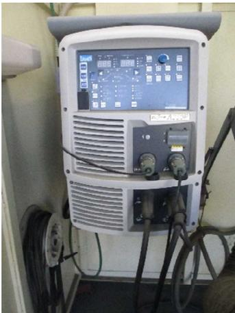
T I G溶接（タングステンイナートガスアーク溶接）は、近年、企業での導入が進みガスタービンブレードなどの精密な溶接作業が多くなっている。今までは、T I G溶接の実習回数は機器の老朽化や実習機器台数が少ないため非常に少ない実習回数だったが、デジタルT I G溶接機の導入により実習回数やものづくりの機会が増え、リモコンによる電流調整やデジタルインバータなど企業で行われている最新のT I G溶接作業を学ぶことが可能となった。
