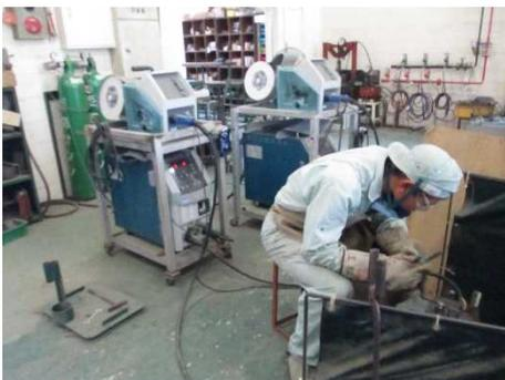
炭酸ガス（CO<sub>2</sub>）半自動溶接は、被覆アーク溶接に比べ高能率で、造船をはじめ車両製造、橋梁、建設現場など幅広く社会で使用されている。
