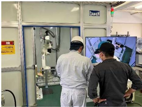
現代の「ものづくり」はプログラム制御によるロボットによる生産が主流になってきた。今まではロボット制御を学べる実習機器がなかったが、6 軸ロボットを導入しロボット作業の安全学習、ティーチング、ファイバーレーザー加工などの最先端のデジタル技術を学ぶことが出来る。今後この設備は学科の枠を超えて実習を行う予定。
