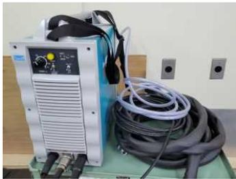
材料の切断に使用、複雑な形状や曲線の切断に使用できる。材料の細かな加工にも便利に使用できている。
