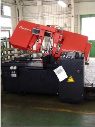
機械科実習の軸となる機械加工において最も使用頻度の高い設備である。旋盤加工で使用する為には、長尺の丸棒を 100 mm～200 mmの長さ<sup>①</sup>に切断する必要がある。その切断をプログラム設定により自動で行うことができる。また 2 mmや 3 mm程度の薄切りも正確に切断することが可能で、それを鍛造実習で自由鍛造を行い、手作りの風鈴製作等を行っている。
